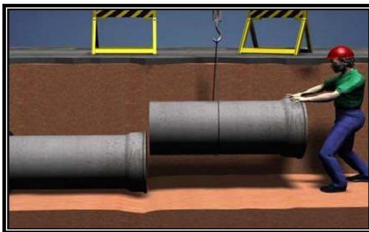
Figura 17 – Acoplamento de tubos de concreto
